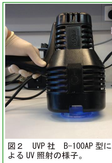
図 2 UVP 社 B-100AP 型による UV 照射の様子。
