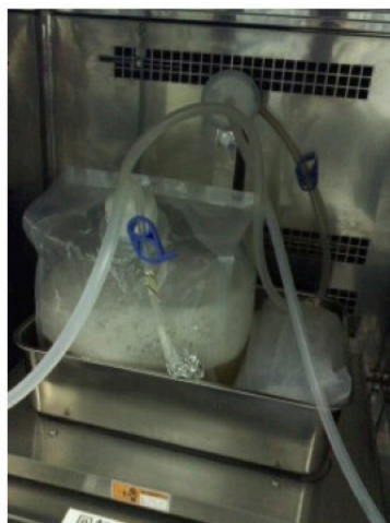
図 2: 実際の培養の様子。A. エアインキュベーター内に設置したカルチャーバッグ(写真撮影のため振とうを停止し、エアインキュベーターの前扉を開放)、B. 排気洗浄用ビンと最終トラップ用ビン。
