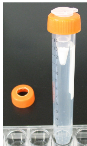
図7: バイオビーズ混合液から再構成液を遠心濾過分離するチューブ遠心後、17mL チューブ底にたまった濾液を回収する。
