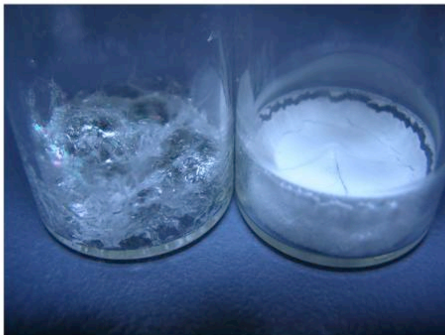
図2: 凍結乾燥により構造崩壊(コラプス)した固体と多孔質固体の例
