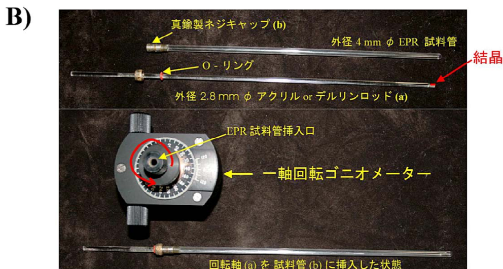
図 10 一軸回転用単結晶EPRゴニオメーター
