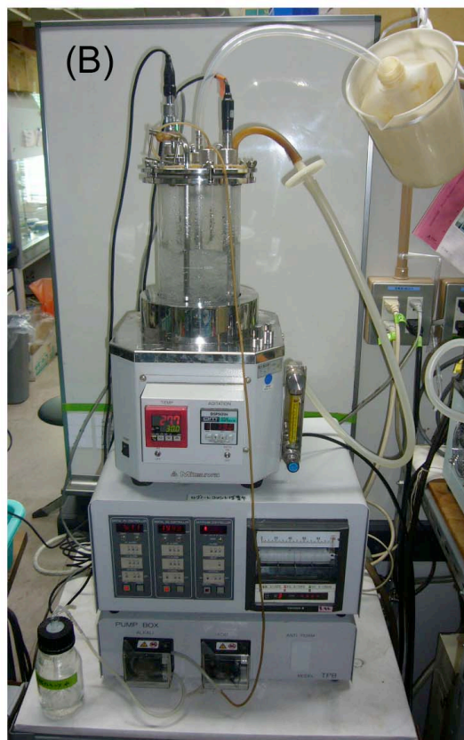
図 1. (A) 上:pH電極、下: DO電極. いずれもTOA-DKK社製. (B)ジャーファーマンター. ミツワ理化学社製. ジャーの上部にpH, DO電極が取り 付けられているのが見える.
