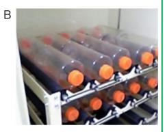
図 1: ヒト細胞発現系の写真 (A) 15 cm ディッシュを用いて  $37.0^{\circ}$ C, 5.0%  $CO_2$ の環境下で細胞培養を 行なっている。(B) ローラーボトルを用いて  $37.0^{\circ}$ C, 5rpm の環境下で細胞培養を行なっている。
