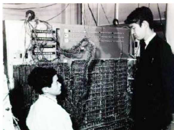
図 9. パラメトロン計算機 PC-1 PC-1 の前に立つのは、高橋秀俊教授と後藤英一・大学院学生
