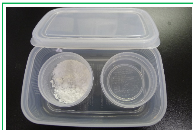
図 1：粉末試料を水和している様子
