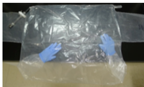
図4：外気と遮断して試料調製する際のグローブバッグ
