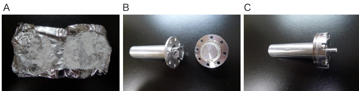
図5：中性子散乱測定に用いられる円筒型セルと挿入するサンプルの例
