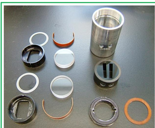
図 3：超遠心分析測定用サンプルセルの部品
