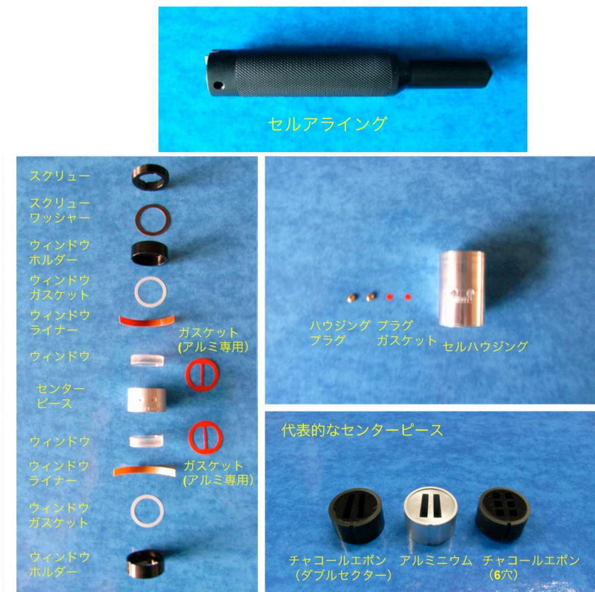
図 3: 超遠心分析に用いるセル。セルアセンブリ（左）をセルハウジング（真中右）にセットし、プラグで蓋をする。（最上）ローターへのセルのセットや位置合わせ、セルハウジングから各パーツの押し出しなどに使うセルアライニング。（右下）センターピースの代表例。42000rpm よりも高速の回転の場合にはアルミニウムのセンターピースを用いる。6 欠セルは同時に 3 種類の試料が測定できる。
