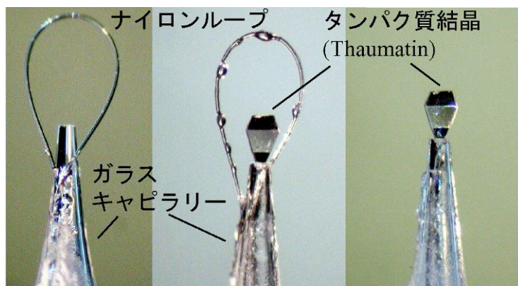
図3 結晶をクライオ条件下で、バッファフリーマウントした写真。左：マウント前 中：バッファを吸引して凍結させた状態 右：ループを取り除いた状態
